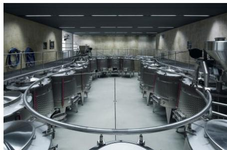
Maischegärung von 10 Tagen im Stahltank und teils im Holzgebinde. Anschließender Säureabbau im Holzfass. Reifung in Barriquefässern aus französischer Eiche für eine Dauer von 10 Monaten. Ein hochmoderner Gärkeller ermöglicht seit 2015 eine höchst schonende Verarbeitung der Trauben mit Ganzbeerenverarbeitung und auch der Verarbeitung ganzer Trauben unter Nutzung der Schwerkraft. Die sensible Abbeermaschine und
